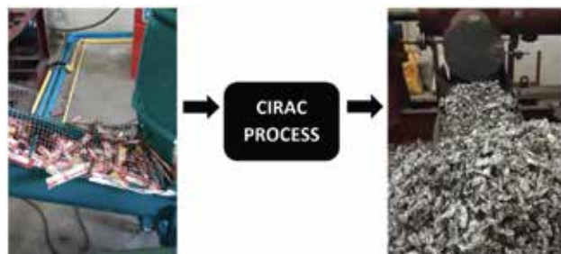
Hình 1: Hệ thống CIRAC chuyển đổi bao bì snack thành nhôm (sản phẩm chính) và dầu nặng (sản phẩm phụ)
