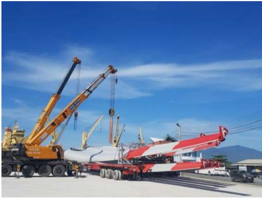
Hình 32. Quá trình vận chuyển một cánh tuabin dài 57 m bằng đường bộ tới địa điểm xây dựng Nhà máy điện gió Trung Nam - Ninh Thuận 68
