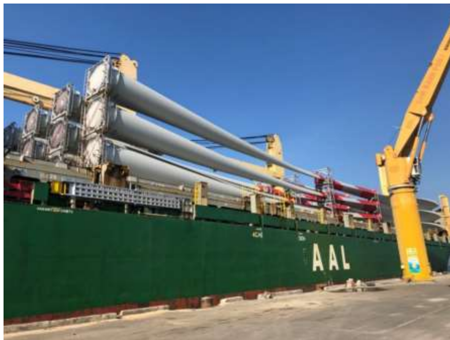
Hình 33. Vận chuyển đường thủy của cánh tuabin dài 57 m tới địa điểm xây dựng nhà máy điện gió Trung Nam-Ninh Thuận 69
