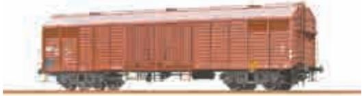
Крытый вагон предназначен для транспортировки по железным дорогам тарно-штучных, штабельных, пакетированных и некоторых сыпучих (зерно) грузов, требующих защиты от атмосферных осадков. Используется как универсальное транспортное средство, для перевозки грузов не требующих особых условий транспортировки.
