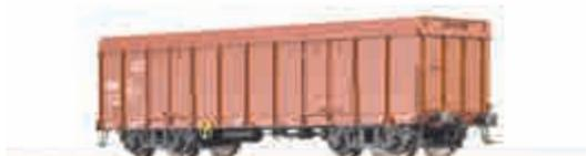
Используются для перевозки массовых неагрессивных, насыпных и навалочных грузов (руда, уголь, флюсы, лесоматериалы и т.п.), не требующих укрытия от атмосферных осадков, а также штабельных и штучных с креплением их в соответствии с Правилами погрузки и крепления грузов.
