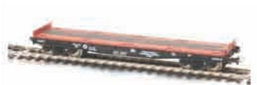
Предназначена для перевозки, длинных и громоздких грузов, преимущественно, лесоматериалов, строительных материалов, контейнеров, машин на колесном ходу в пределах внутреннего габарита данного вагона, не требующих укрытия от атмосферных осадков. С выгрузкой на пунктах, имеющих приемо-разгрузочные устройства, при условии, что способы размещения и крепления
