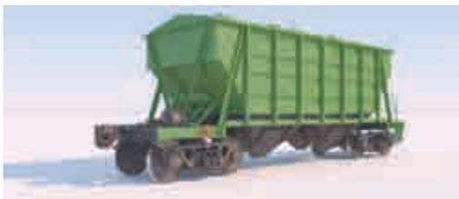
Вагон-хopper обеспечивает перевозку по железным дорогам зерна и других аналогичных пищевых продуктов насыпью с гравитационной погрузкой через верхние люки. Привод механизма разгрузки ручной. Данный вагон используется также и для перевозки минеральных удобрений, при этом в качестве лакокрасочного покрытия кузова вагона применяется эмаль на основе эпоксидных смол.
