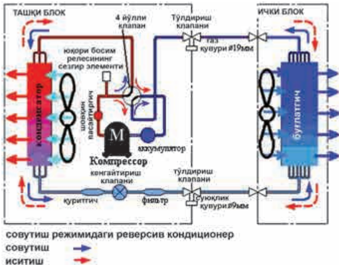
9-расм. Сплит-кондиционер схемаси.
