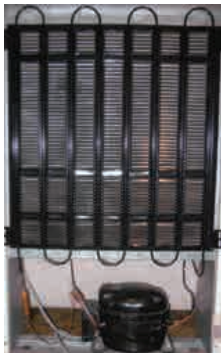
18-расм. Уй рўзгор совитиш машинасининг компрессор-конденсатор агрегати
