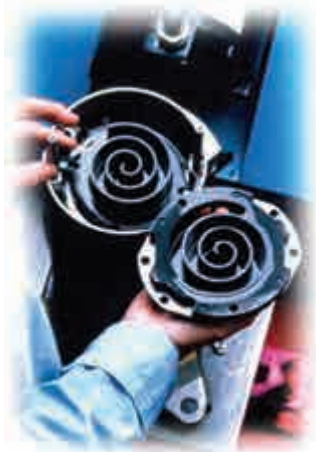
16-расм. Спираль компрессорнинг ишлаш принципи.
