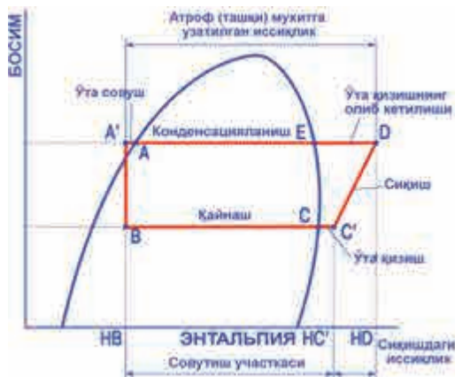
7-расм. Совитиш назарий циклининг энтальпия (иссиқлик сақлами)-босим диаграммасидаги тасвири
