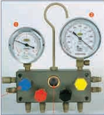
Рис.69. Современный манометрический коллектор
