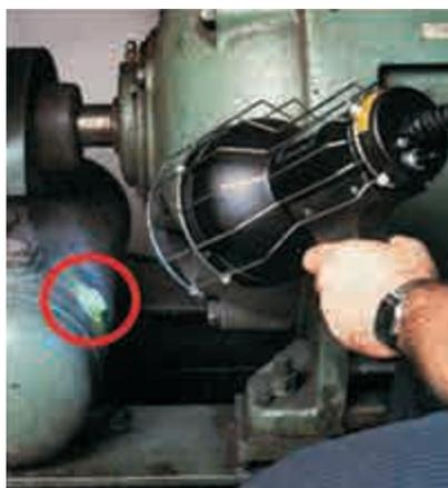
Рис.51. Ультрафиолетовая лампа
