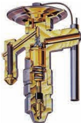
Рис.29. Разрез ТРВ
