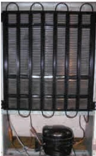
Рис.18. Компрессорно-конденсаторный агрегат бытового холодильника
