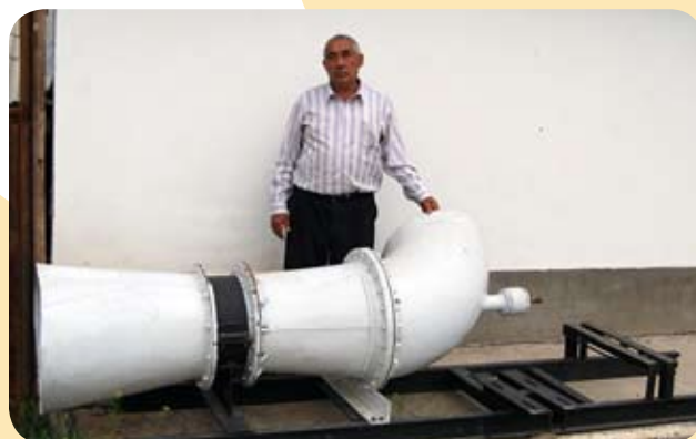
Ҳозирги пайтда Р.Тошматов 10–80 кВт қувватга эга гидротурбиналарни ясаш технологиясини ўзлаштирди.
