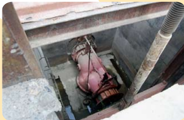
Турбина микро гидроэлектростанции, которую Рустамжон Ташматов самостоятельно изготовил в селе Заврак.
