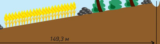
Схема размещения позахватных полос и водозадерживающих канав при травопольном севообороте на темных сероземах низкогорий до 1000 м н.ум. и коричневых почвах выше 1000 м н.ум. при крутизне склона 15 градусов
