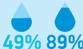
КПД канала до и после пластиковой изоляции
