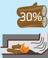
экономия дров за счет установки "юбки" для длительного сохранения тепла дрова подкладывают ближе к дверце, а золу сдвигайте в глубь
