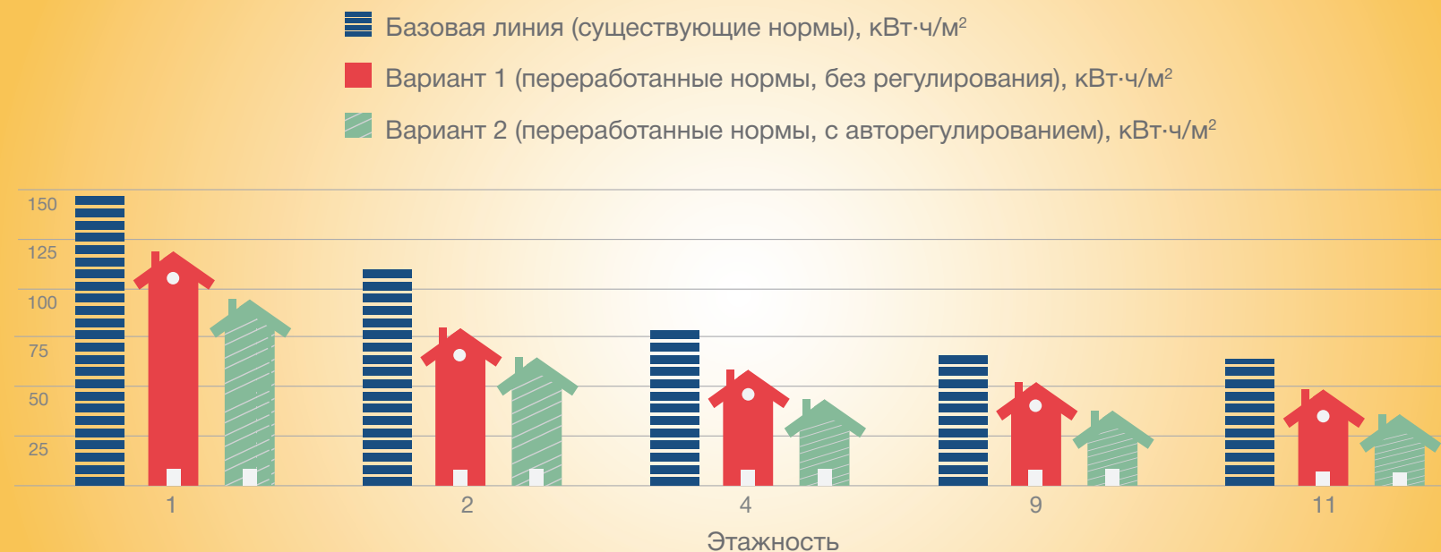
Рисунок 4.7. Удельный расход тепловой энергии на отопление и вентиляцию жилых зданий при переходе от старых норм сопротивления теплопередаче ограждающих конструкций (базовая линия) к новым нормам при вариантах регулирования температуры теплоносителя в системе отопления
