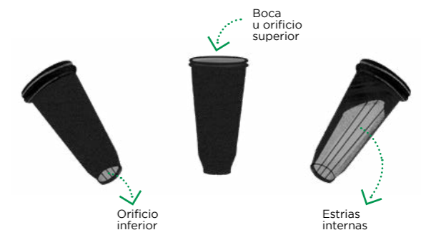
Figura 35. Partes de los tubetes.
