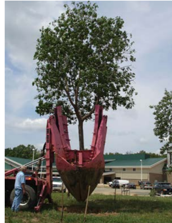
Figura 71. Cepellonadora con espadas de accionamiento hidráulico montada en un camión, protegida con un lienzo, listos para ser expedidos para su plantación en el lugar definitivo.
