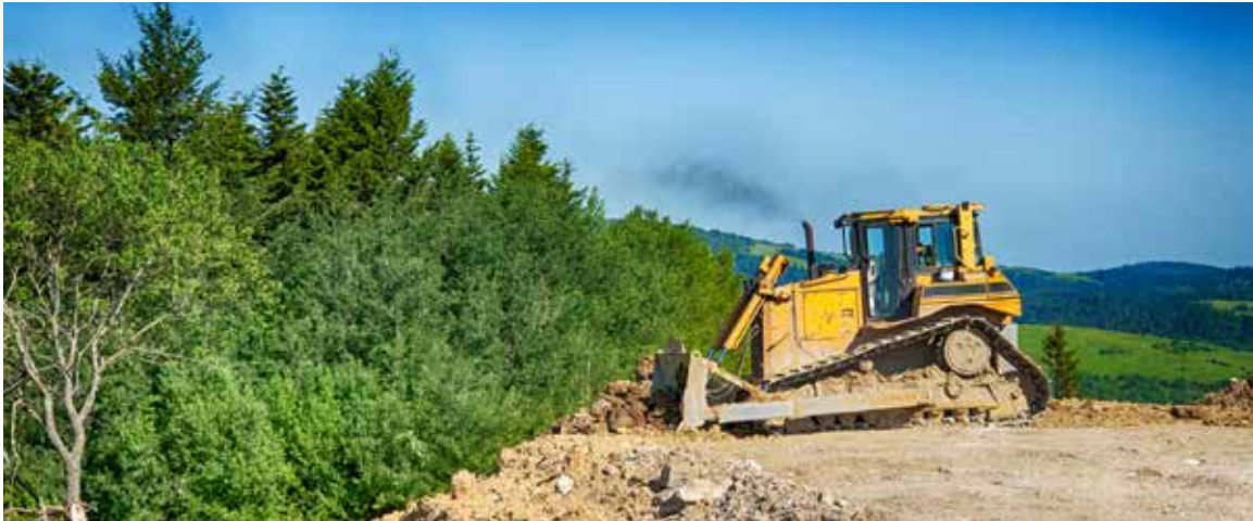
Ilustración 58. Tractor con oruga con láminas de empuje de altura aumentada de barras
