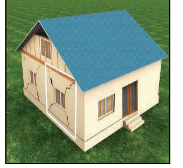
भ्याल ढोकाका कुनाबाट शुरु भएका विकर्ण चिराहरू तथा गारोको वारपार छिचोल्ने विकर्ण चिराहरू
