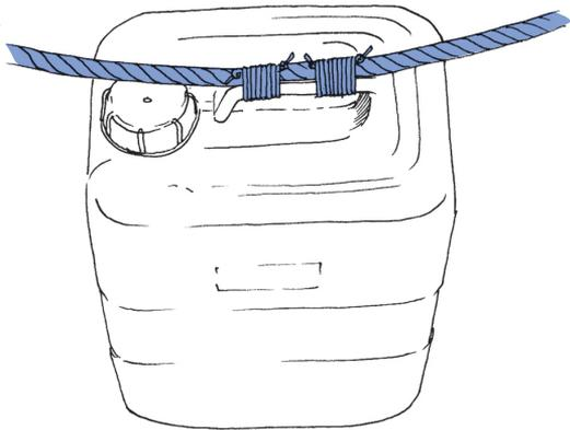
شکل 13: نحوه بستن طناب به حلقه فلزی در ظروف پلاستیکی
