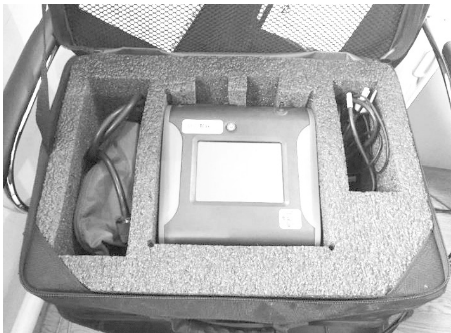
Зураг 4. Тавантолгой ХК-ийн тоосжилтийн хэмжилт хийхэд ашиглаж буй DustTrak TSI 8530 зөөврийн багаж
