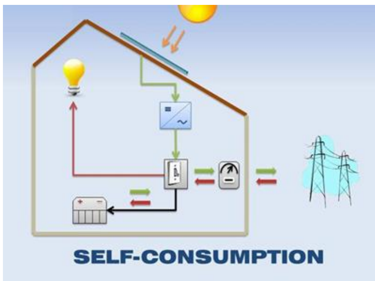
Slika 1. Principijelna šema instalacija kupca - proizvođača
