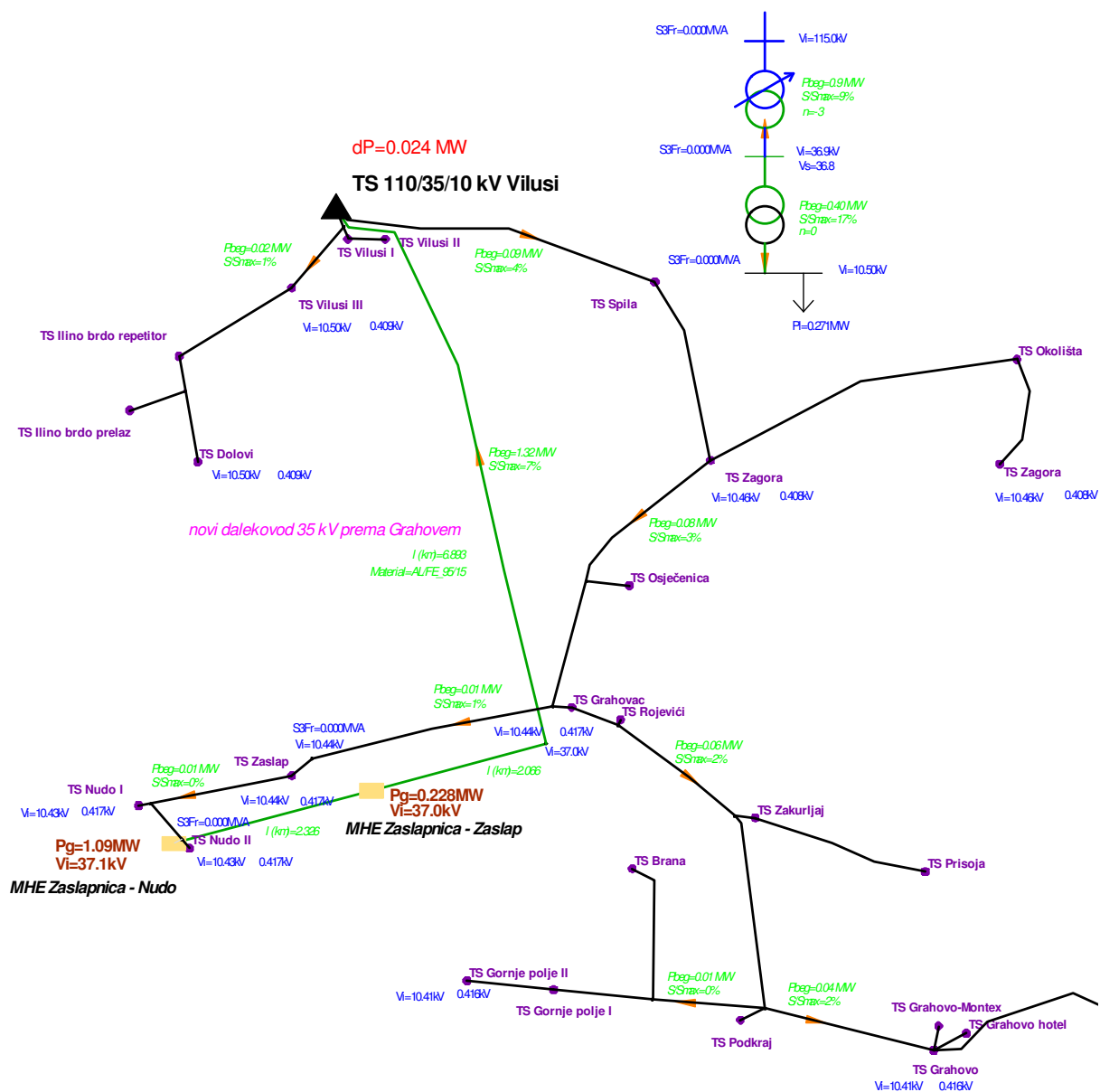
Sl. 5.9: Rezultati analize energetske prilike – priključenje mHE na novi izvod Grahovo 35 kV, minimalna opterećenja, 2011.
