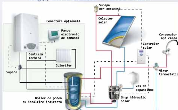
Imag.[1] Schema circuitului cu colectoare solare
