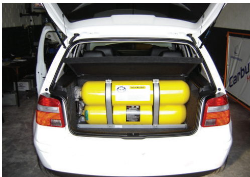
Figura 22. Instalație de gaz natural comprimat 28
