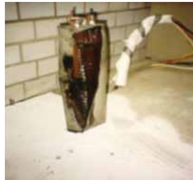
Foto 29. Un capacitor que explota.
