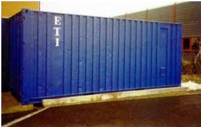
Foto 55. Contenedor de 20' con una bandeja de goteo.
