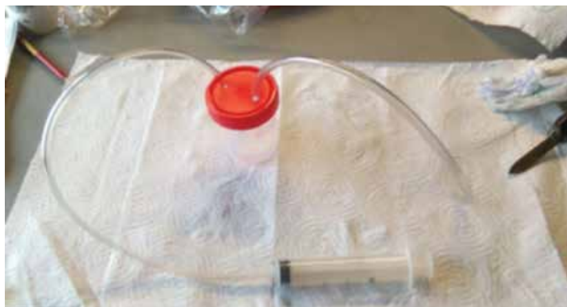
Foto 18. Adaptación de recipiente para toma de muestra.
