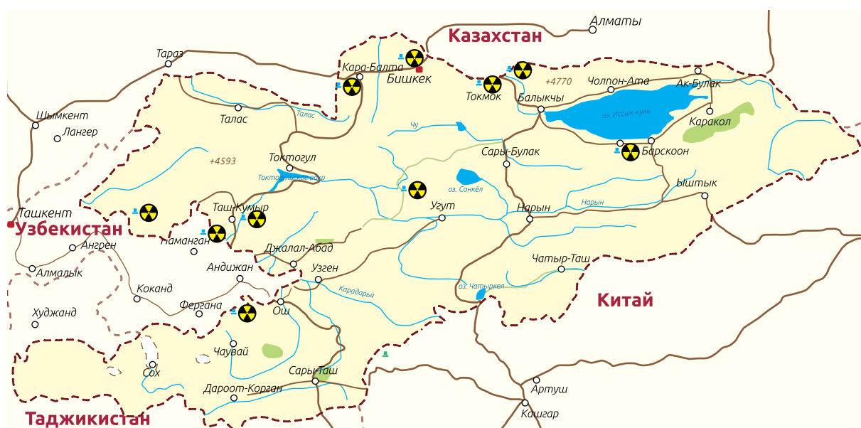
Рисунок 9.3. Расположение радиоактивных хвостохранилищ и отвалов в Кыргызстане Источник: Кадастр отходов горнодобывающей промышленности Кыргызской Республики
