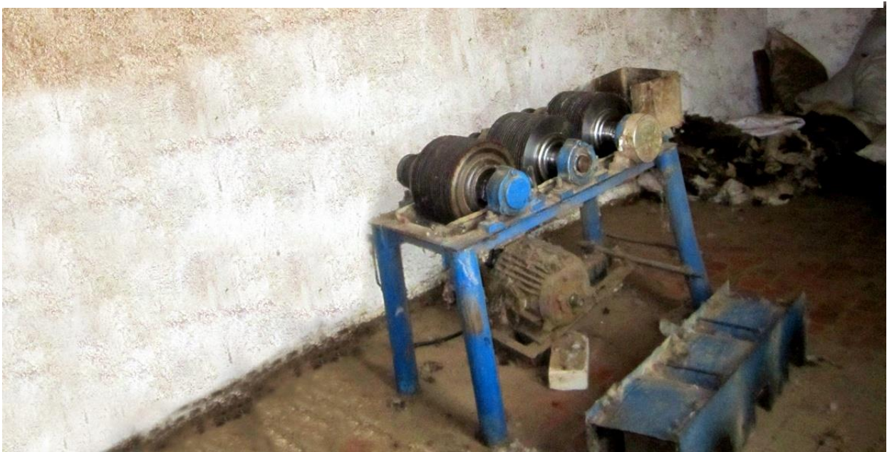
Фотография 3. Аппарат прочесывания шерсти в мастерской Анары. Источник: Ким 2014
