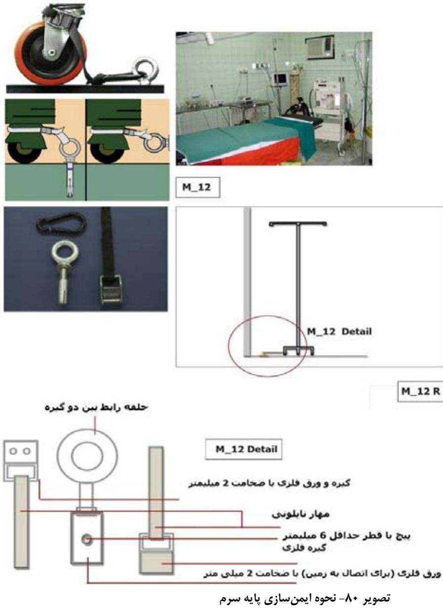
برای مهار پایه سرم باید از مهار نایلونی که از یک سر به چرخ ترالی و از سر دیگر به حلقة پیچ شده در زمین متصل است، استفاده شود.
