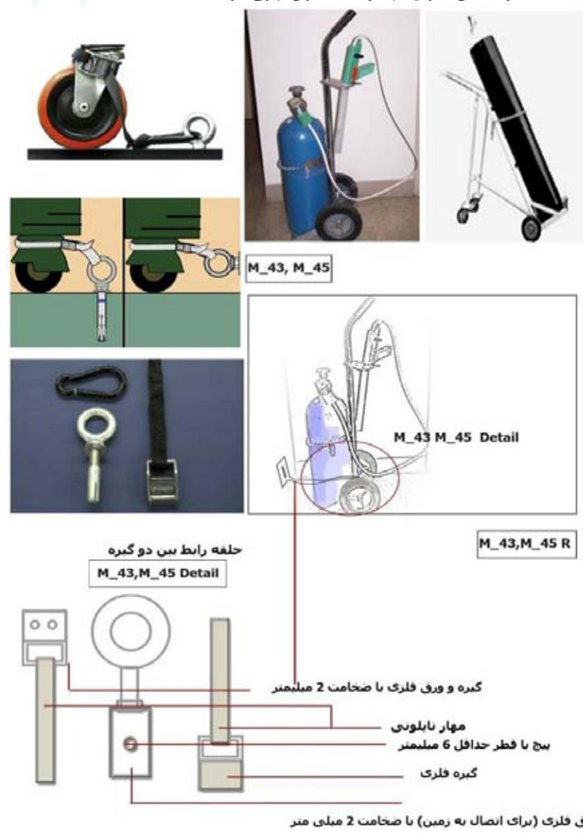
برای مهار کپسول اکسیژن چرخ دار باید از مهار نایلونی که از یک سر به چرخ تراالی و از سر دیگر به حلقه پیچ شده در زمین متصل است، استفاده شود.
