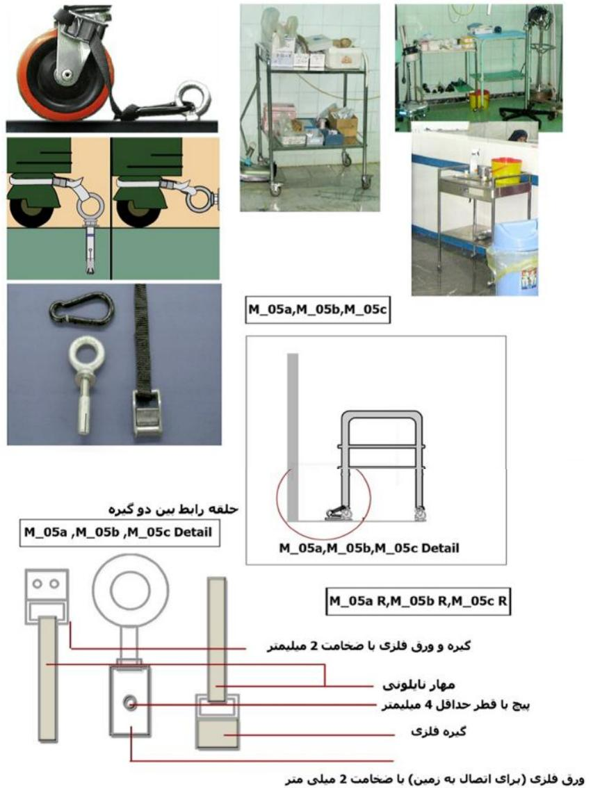
شکل ۲۹- اتصال میز چرخ دار به دیوار توسط حائل بند
