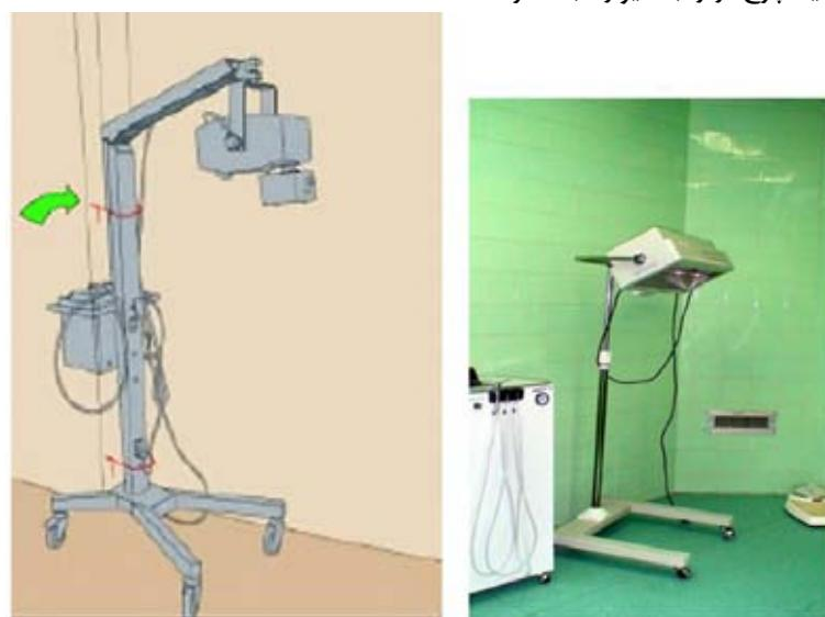
تصویر ۲۸- اتصال یک دستگاه پزشکی چرخ‌دار به دیوار توسط حائل بند
