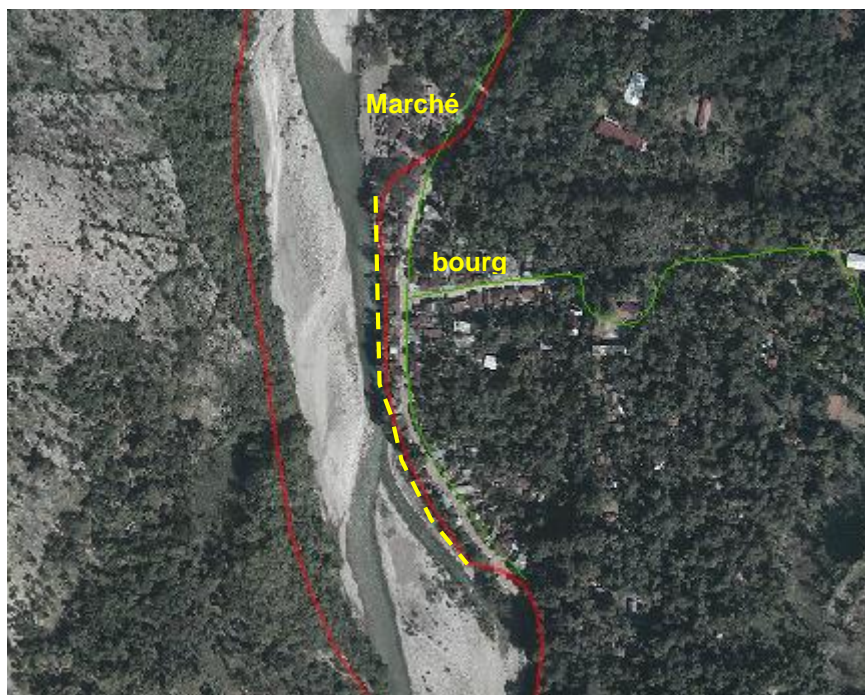
Fig. 13. Vue aérienne de Léon. En rouge le contour approximatif de la zone inondable maximale connue. En jaune le linéaire de gabions installé en 2013.
