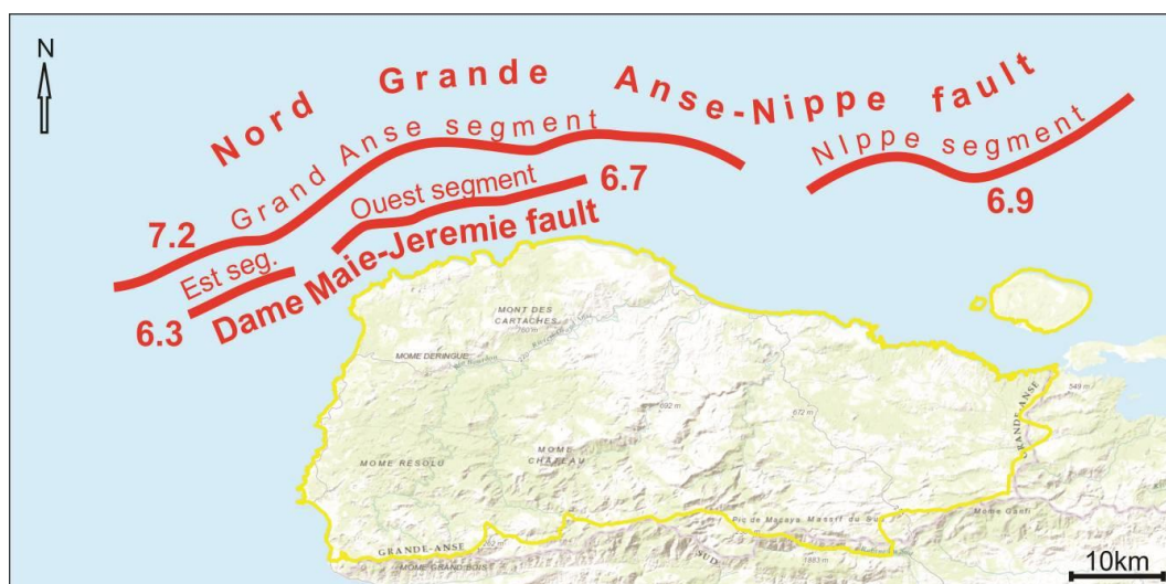
Fig. 30. Magnitude des segments du système de faille Nord Grand'Anse-Nippe
