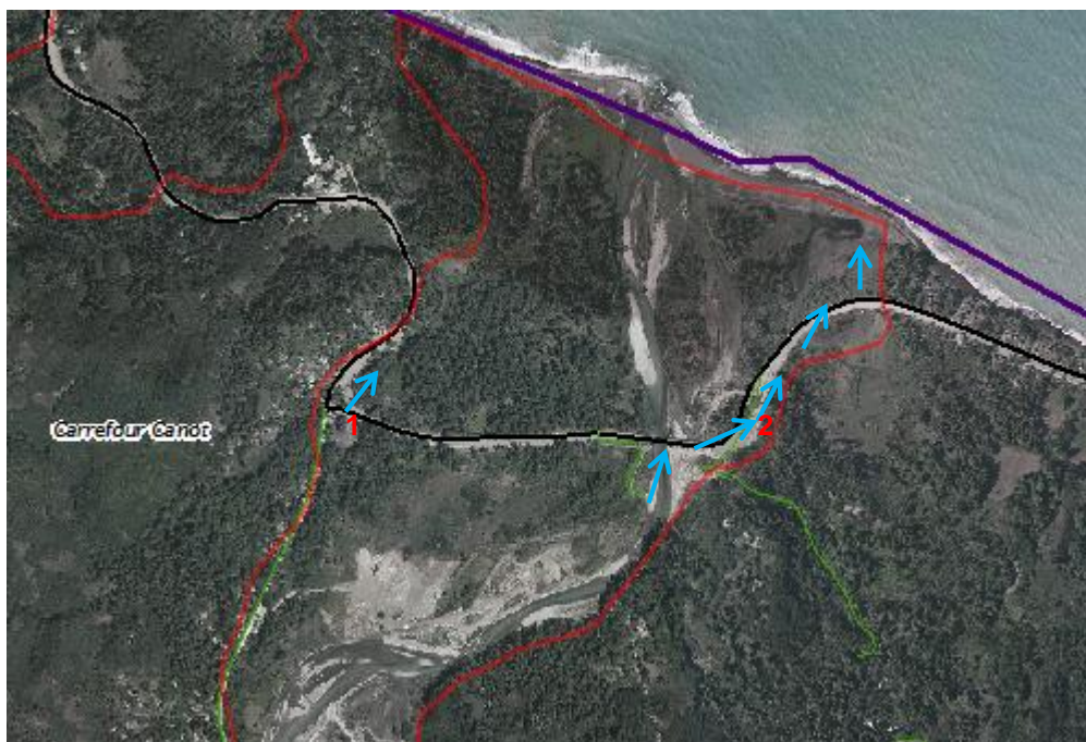
Fig. 15. Dynamique de l'inondation de la rivière Voldroque à Carrefour Canot. En rouge la limite approximative de la zone inondable maximale.
