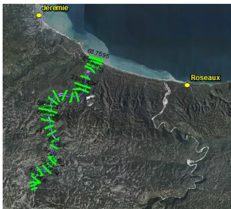
Fig. 27. Emprise du modèle hydraulique de la Voldrogue
