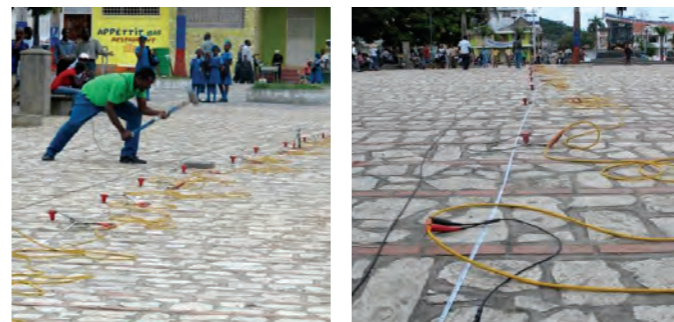
Mesure de sismicité mise en œuvre dans le cadre de l'étude « Microzonage sismique » à Port au Prince
