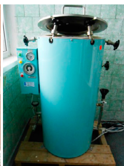
Автоклав для обеззараживания отходов
