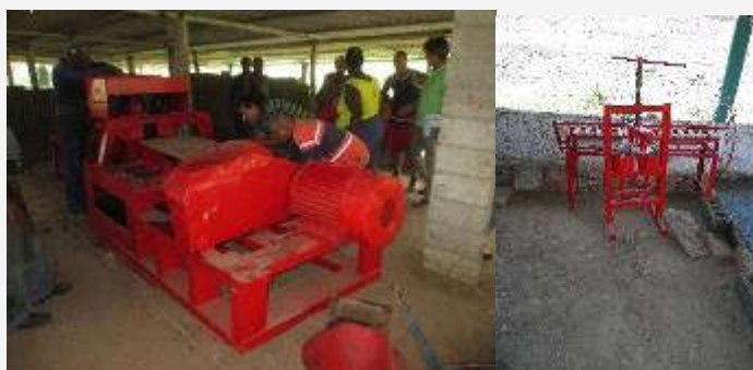
Equipamiento reparado: Extrusora, gradillera, briquetadora
