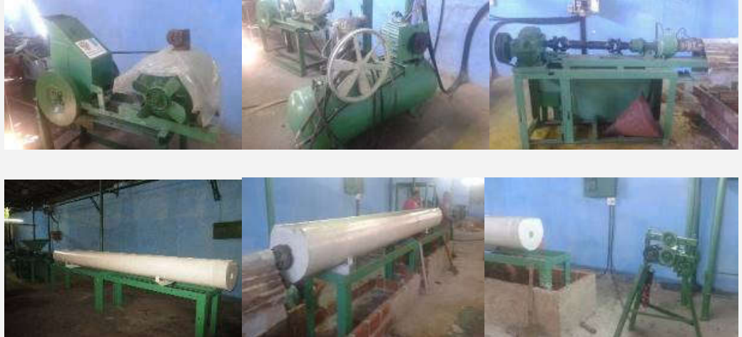
Equipos elaborados por el innovador local, para producción de tuberías y conexiones hidráulico-sanitarias a partir de plástico reciclado. Por su orden: Molino para triturar el plástico que se recicla, compresor, extrusora para la producción de tuberías hidráulicas
