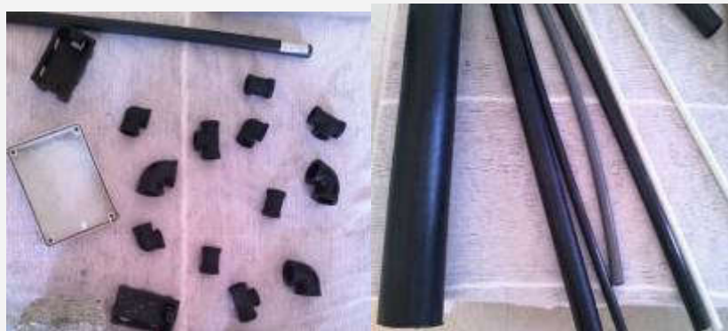
Mostrario de producciones de tuberías hidráulicas, sanitarias y para instalación eléctrica; conexiones hidráulicas (codos, "te" y nudos), así como cajas eléctricas. Entre las proyecciones para los próximos años se espera que esta producción apoye la campaña de reparación de salideros de agua en edificaciones, como parte de la estrategia del territorio de enfrentamiento a la sequía que afecta actualmente a la provincia
