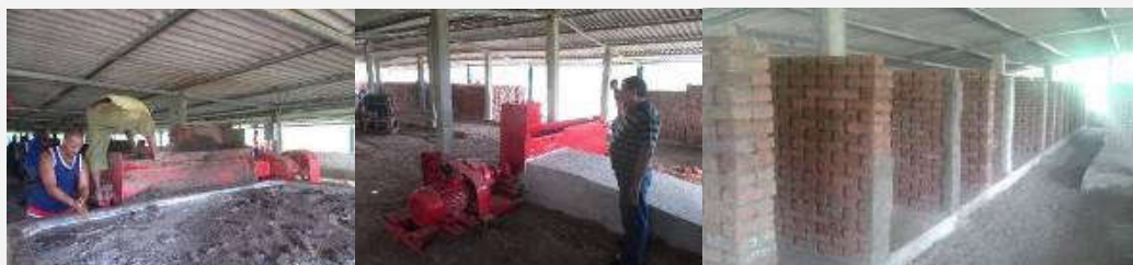
Pudridero de arcilla / Rampa y extrusora reparada / Secciones divisorias para el secado de las tejas
