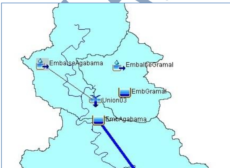
Figura 4.17. Conexión entre un elemento subcuenca y un elemento confluencia
