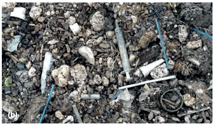
Figura 5 – a) Sólidos retenidos en una unidad de tamizado de 6mm; b) presencia de sólidos en lodo y en nata deshidratada en lechos de secado.
