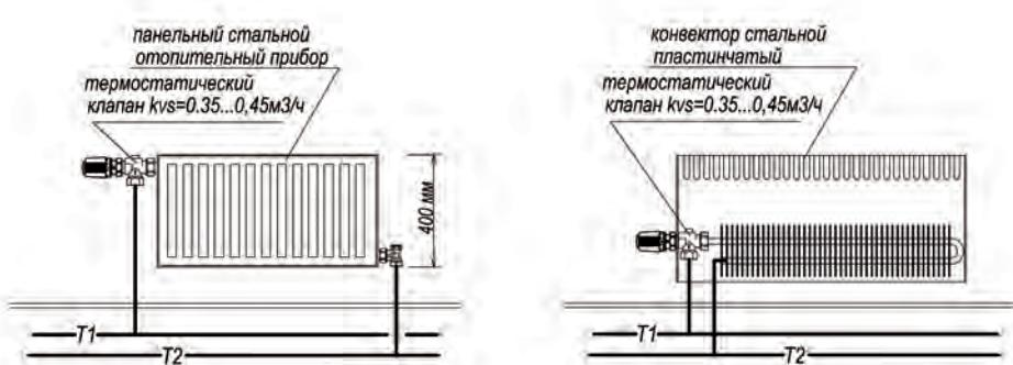
Рис.14. Предлагаемые варианты конвективного низкотемпературного отопления
