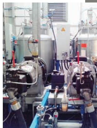
NUEVA MÁQUINA DE INYECCIÓN DE ESPUMAS QUE UTILIZAN LA TECNOLOGÍA DEL CICLOPENTANO COMO AGENTE ESPUMANTE. FOTO DE WALTON HI-TECH INDUSTRIES Y LA OFICINA NACIONAL DEL OZONO DE BANGLADESH.
