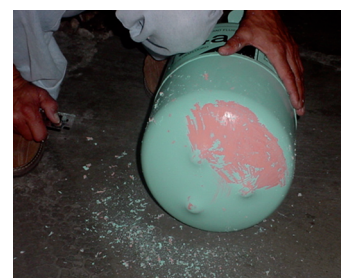
Figura 5: Cilindro de CFC 12 pintado com a cor de identificação do fluido HFC-134a (Fonte: IBAMA, 2005)
