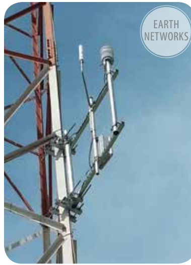
CAPTEUR DE LOCALISATION DE LA Foudre UBIMET/NOWCAST. CRÉDIT PHOTO : REPRODUCTION AVEC L'AIMABLE AUTORISATION DE UBIMET
