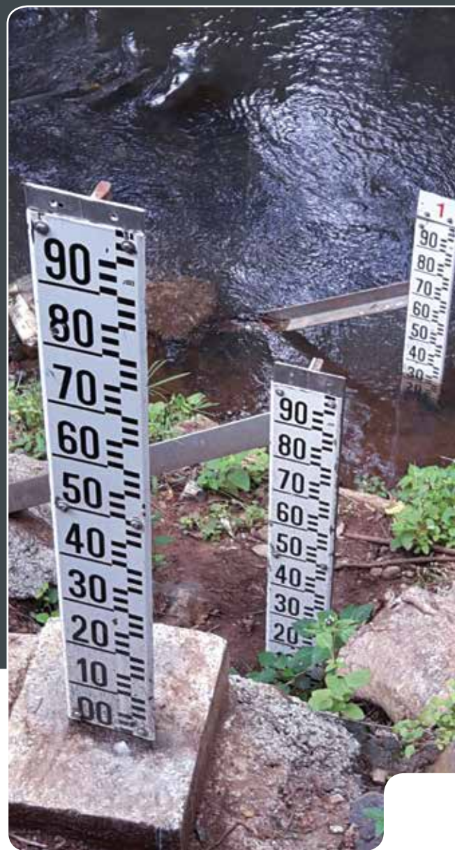
UNE SÉRIE D'ÉCHELLES LIMNIMÉTRIQUES UTILISÉES POUR OBSERVER MANUELLEMENT LE NIVEAU DES COURS D'EAU.
