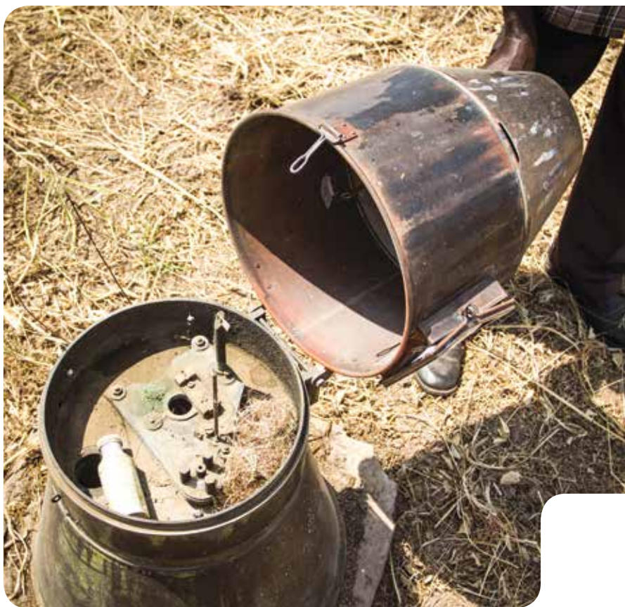
UN PLUVIOMÈTRE ENDOMMAGÉ EN OUGANDA. CRÉDIT PHOTO : JOOST HOEDJES
