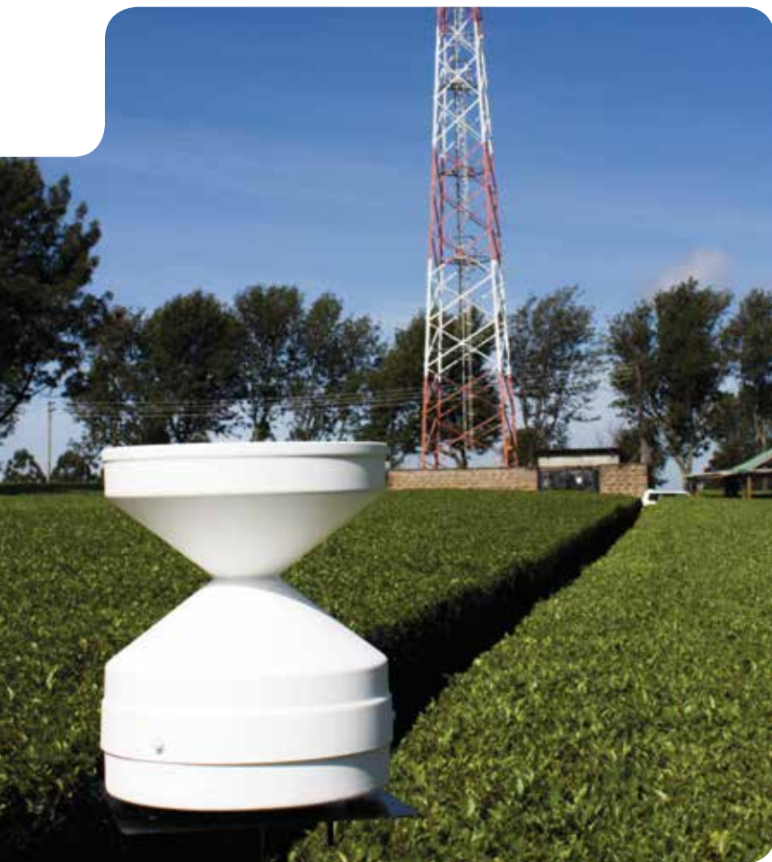
LES SITES DES ANTENNES-RELAIS PEUVENT SERVIR À INSTALLER DES ÉQUIPEMENTS MÉTÉOROLOGIQUES, SOIT SUR L'ANTENNE ELLE-MÊME, C'EST LE CAS DES STATIONS MÉTÉOROLOGIQUES AUTOMATIQUES OU DES CAPTEURS DE LOCALISATION DE LA Foudre, SOIT À CÔTÉ, C'EST LE CAS DU PLUVIOMÈTRE REPRÉSENTÉ SUR LA PHOTO. LE RÉSEAU DE TÉLÉPHONIE MOBILE PEUT ÉGALEMENT ÊTRE UTILISÉ POUR DIFFUSER DES ALERTES PRÉCOCES ET DES INFORMATIONS CLIMATIQUES. CRÉDIT PHOTO : JOOST HOEDJES
