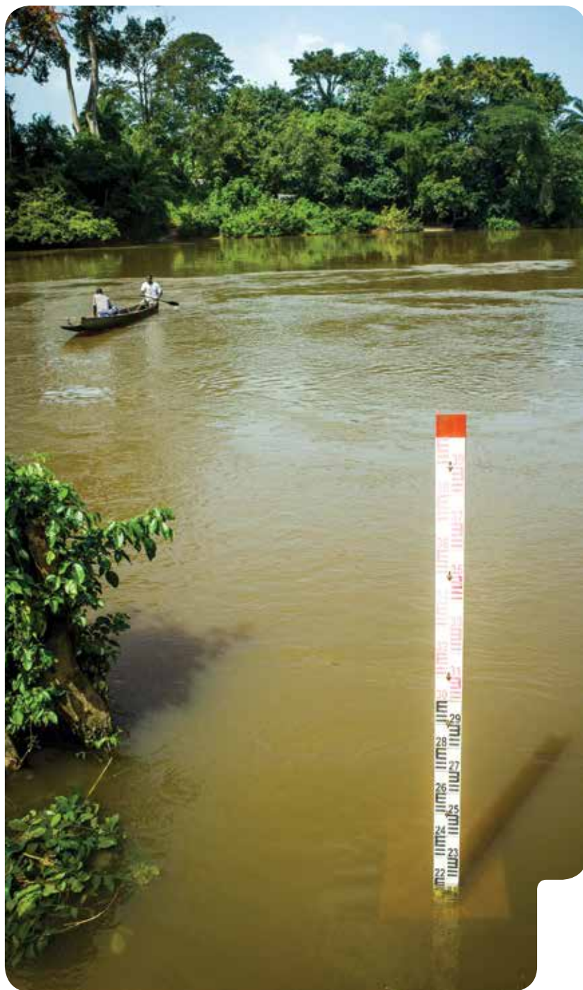
UN LIMNIMÈTRE TRADITIONNEL AU LIBÉRIA. CRÉDIT PHOTO : JOOST HOEDJES
