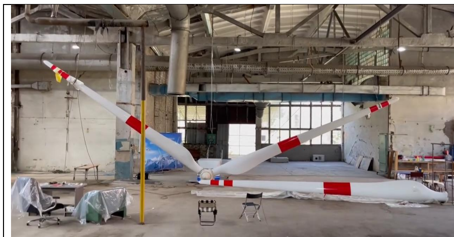
Пилотная ВЭС 100кВт «Ак-Олон» перед установкой в ветропарке.
