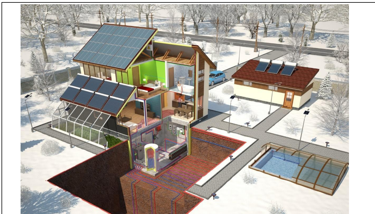
ЦРВИЭЭ, схема работы солнечных водонагревательных, фотоэлектрических систем и теплового насоса, использующего низкопотенциальную энергию земли.
