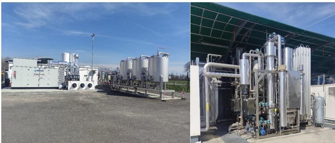
Slika 6: Deo postrojenja za prečišćavanje biogasa do utečnjelog biometana uklanjajući H 2 S i sušenje (levo), kriogeno hlađenje za odvajanje CO 2 (desno)
