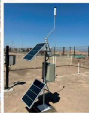
Imagen 5. Sistema detección de tormentas. Están instalados ocho sensores, que dan soporte al servicio. (Aeropuertos de Arica, Iquique, Antofagasta, Calama y Copiapó), Municipalidad de Taltal, San Pedro de Atacama, El Salvador. Estos permiten fortalecer el sistema de alerta temprana del norte del país.
