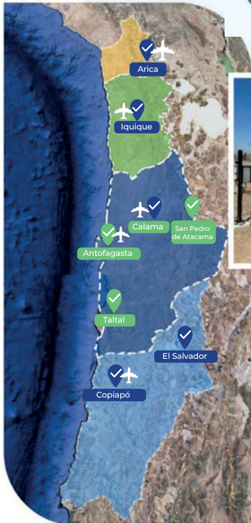
Imagen 5. Sistema detección de tormentas. Están instalados ocho sensores, que dan soporte al servicio. (Aeropuertos de Arica, Iquique, Antofagasta, Calama y Copiapó), Municipalidad de Taltal, San Pedro de Atacama, El Salvador. Estos permiten fortalecer el sistema de alerta temprana del norte del país.
