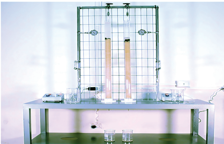
Montaje del sistema escalado del proceso de biosorción en columna de lecho fijo.
