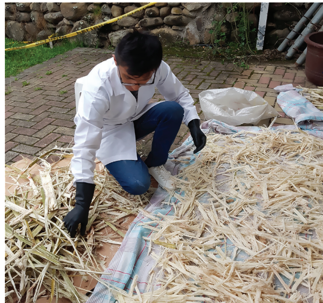
Acondicionamiento de la biomasa: Separación de la corteza de la fibra del bagazo de caña de azúcar.
