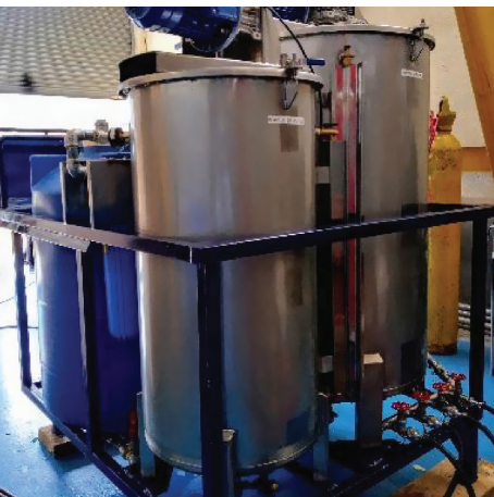
Tanque almacenaje, tanque mezcla de agua, tanque reactor, tanque N 2 , motor agitador.
