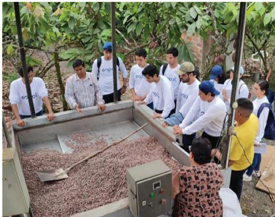
Pruebas de funcionamiento del secador híbrido con producto - Vinculación con la comunidad, estudiantes de ESPOL.
