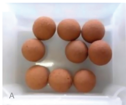
Sorbentes sólidos: (A) pellets, (B) extrudados cilíndricos.
