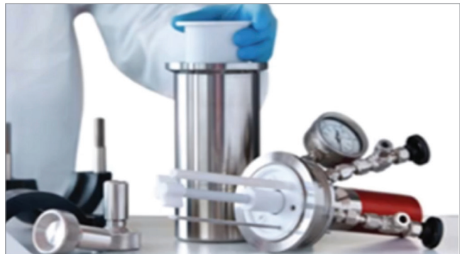
Sintetización de nanoestructuras mediante el método hidrotérmico alcalino.
