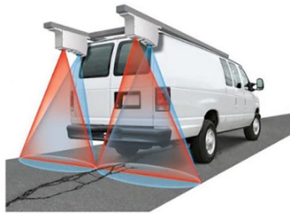
รูปที่ 2-2 ยานพาหนะที่ใช้ในการสำรวจค่าดัชนีความเรียบขรุขระสากล
