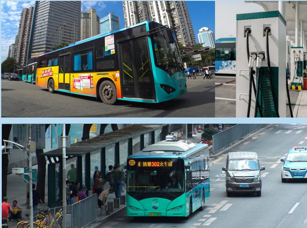
ภาพที่ B รถโดยสารไฟฟ้าและแท่นชาร์จแบบมีหัวจ่าย 4 หัว ในเมืองเซินเจิ้น ประเทศจีน
