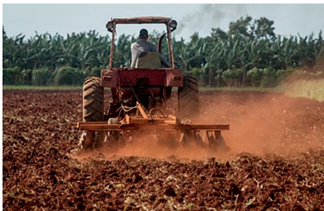
Fig.8. Preparación de suelo con pases de grada de discos para la siembra de las plantas del papayo.
