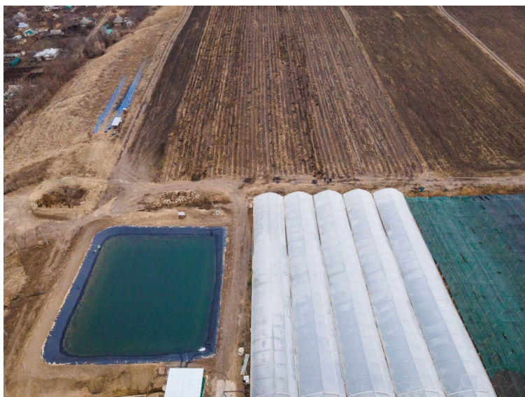
Рис. 14. Система хранения дождевой воды в Антонешть 18
