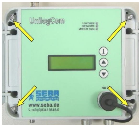
FIGURA 23. UBICACIÓN DE LOS TORNILLOS DE LA TAPA SUPERIOR DEL REGISTRADOR/TRANSMISOR DE DATOS.
