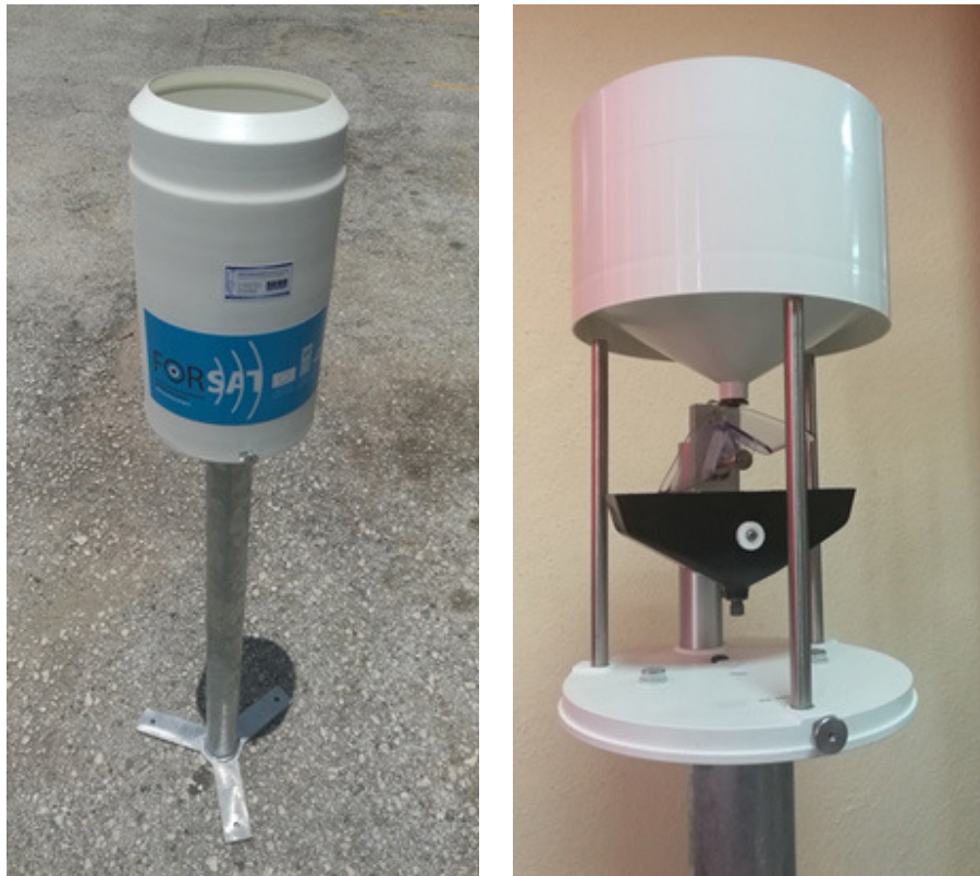
FIGURA 1. PLUVIÓMETRO RG 50 (IZQUIERDA: VISTA EXTERIOR; DERECHA: VISTA INTERIOR).
