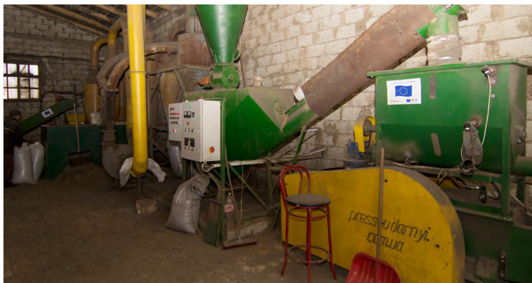
▲ Linia de brichetare de fabricație ucraineană, cu o capacitate de producție de 400 kg/oră
