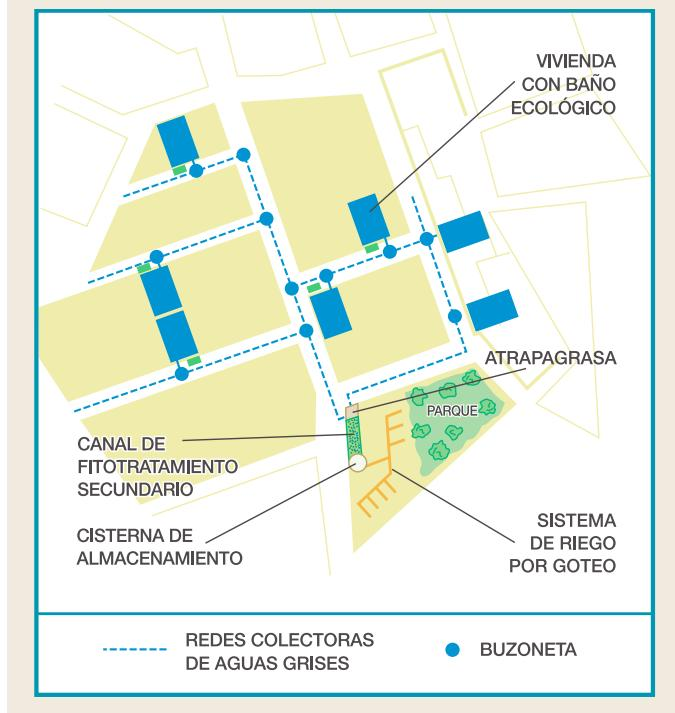
A nivel centralizado, los efluentes tratados de las viviendas eran canalizados a través de un sistema de redes exteriores y conducidos a una segunda etapa de tratamiento mediante un humedal artificial. Con el fin de irrigar el parque del barrio con el efluente final del sistema de tratamiento, se instaló una cisterna de almacenamiento y un sistema de riego por goteo debajo de la superficie, como se muestra en la Figura 8.
